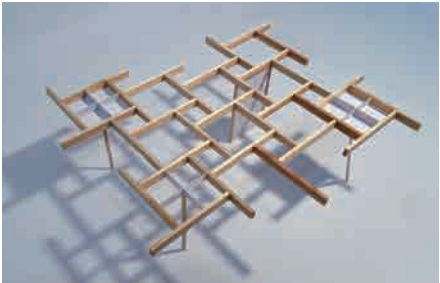
それぞれの梁が影響し合うレシプロカル構造
