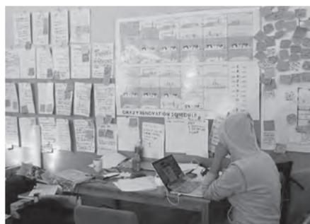
大規模かつ多くの“職人”が参加するDIYとなるため、人工や材料のロスがおこらないよう、最低限の施工上のアドバイスをOOOで行った。具体的には、素人でも工程と作業内容が感覚的にわかる工程表ならぬ「工程図」をA0サイズで作成し、全員が施工状況を把握できる環境を整えるためのサポートを行った。その他、フローリングの削りかたや張り方など簡単なコミュニケーションを取りながら施工を進めた。そのようなガイドを設けてあげると、後は手の動くセンスの良い50人の職人たちが、様々な工夫を行いながらテンポ良く工事を進めていった。余ったフローリング材は靴箱の仕上げになり、オフィスの中心には流木による象徴的な大木が立ち上がった。専門家が最低限のガイドを示すことで、個人感性によるブリコラージュを誘発され、Do It Yourselfならではの良さを引き出すことができた。
